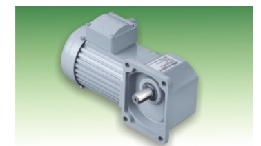
③ FX-F系列（图示为实心右出轴） 功率： 0.1-2.2KW 减速比： 1:5~1:240 特 点： 可付刹车 90°出力轴方向可节省空间
