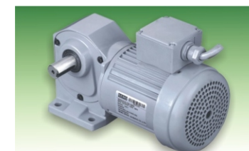
② FX-H系列（图示为实心左出轴） 功率： 0.1-2.2KW 减速比： 1:5~1:240 特 点： 可付刹车 90°出力轴方向可节省空间
