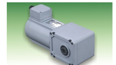
⑥ FX-R系列（图示为空心右出轴） 功率： 25-120W 减速比： 1: 5~1: 240 特 点： 可付刹车/调速器，一体化设计， 结构紧凑，节省安装空间
