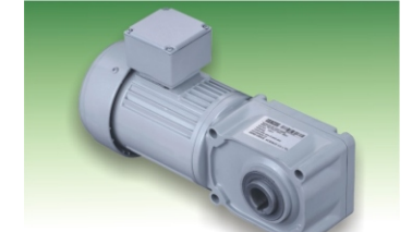
⑥ FX-R系列（图示为空心右出轴） 功率： 0.1-2.2KW 减速比： 1:5~1:240 特 点： 可付刹车 可适应调配多种电机
