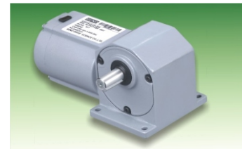
① FX-H系列（图示为实心右出轴） 功率： 25-120W 速比：1: 5~1: 240 特 点： 可付刹车/调速器 尺寸小，安装方便
