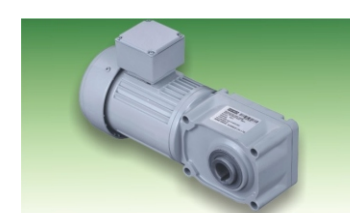
⑤ FX-R系列（图示为空心右出轴） 功率： 0.1-2.2KW 减速比： 1:5~1:240 特 点： 可付刹车 可适应调配多种电机
