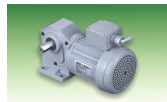
① FX-H系列（图示为实心左出轴） 功率： 0.1-2.2KW 减速比： 1:5~1:240 特 点： 可付刹车 90°出力轴方向可节省空间
