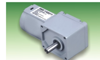
⑤ FX-R系列（图示为实心右出轴） 功率： 25-120W 减速比： 1: 5~1: 240 特 点： 可付刹车/调速器，一体化设计， 结构紧凑，节省安装空间
