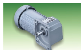
④ FX-F系列（图示为实心右出轴） 功率： 0.1-2.2KW 减速比： 1:5~1:240 特 点： 可付刹车 90°出力轴方向可节省空间
