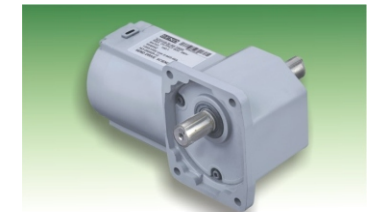
③ FX-H系列（图示为双出轴） 功率： 25-120W 减速比： 1:5~1:240 特 点：可付刹车/调速器 法兰安装，节省安装空间
